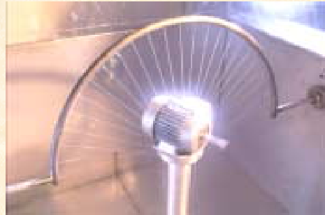
Essai IPX4 sur un moteur
